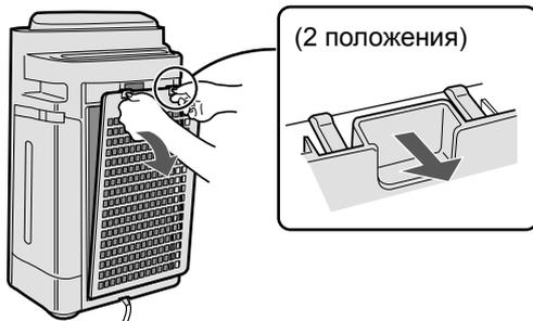
Снимите заднюю панель.
